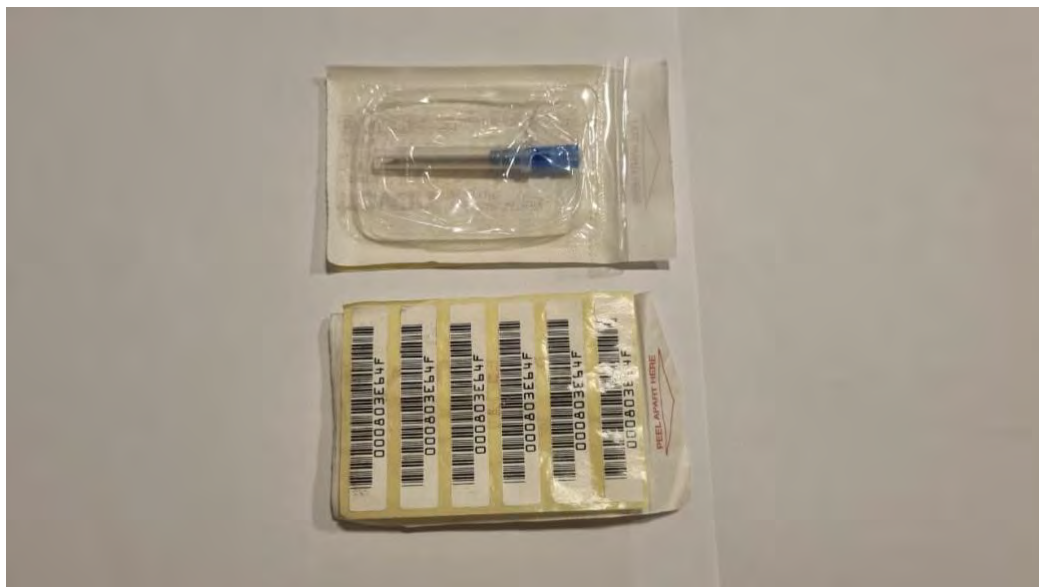
Figura 10 – PIT Tag (Trovan™, modelo 100C) utilizado como ferramenta complementar à marcação com anilhas metálicas em fêmeas de D. coriacea . Fonte: Fundação Projeto Tamar.
